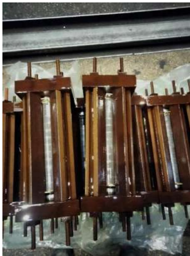
Fig. 1. Surge arrester DPRTU ZE 64 G23
